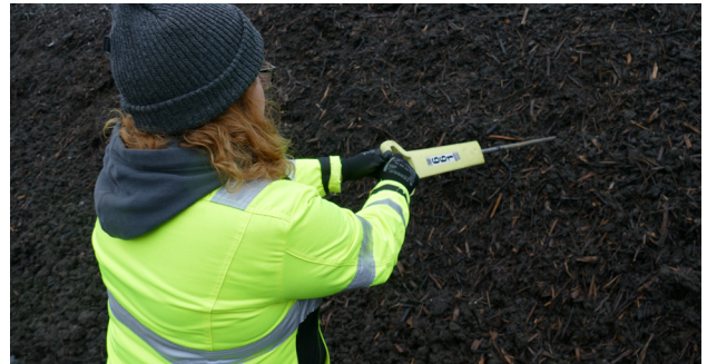
Anturi, jota käytetään kompostiaumojen online-mittauksissa. Kuva: Laura Keskitalo.
