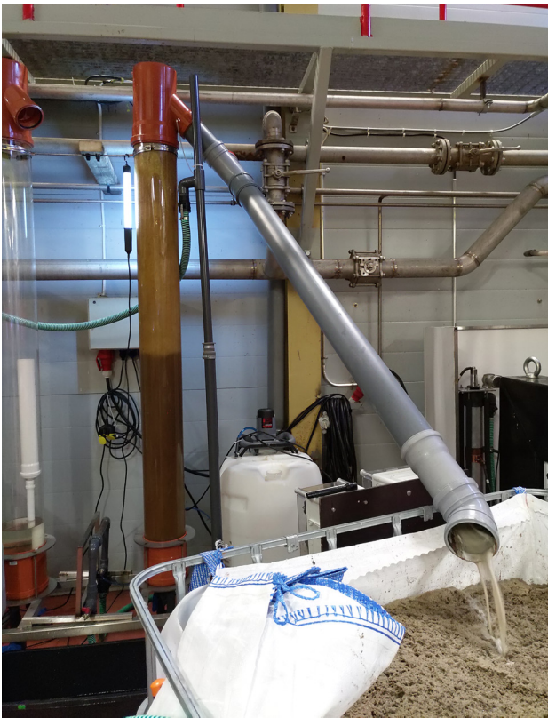
Sähkösaostuskokeilu Stormossenin biokaasulaitoksella syksyllä 2020. Kuva: Mikael Åbacka, Axolot.
